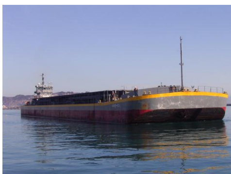
土運船（県内処理で使用）
