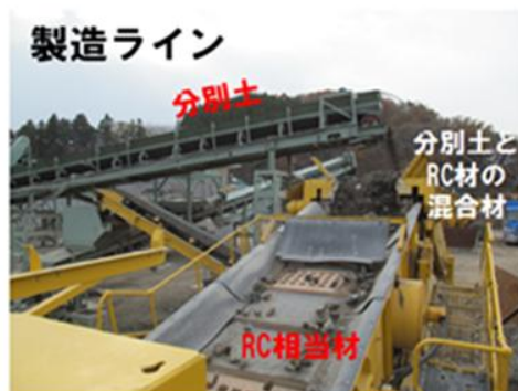
※分別土（津波堆積土）とコンクリートがらの混合による復興資材化（大船渡地区）
